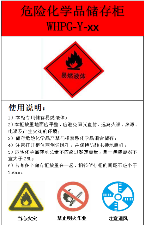
图 A.3 易燃液体储存柜标签
